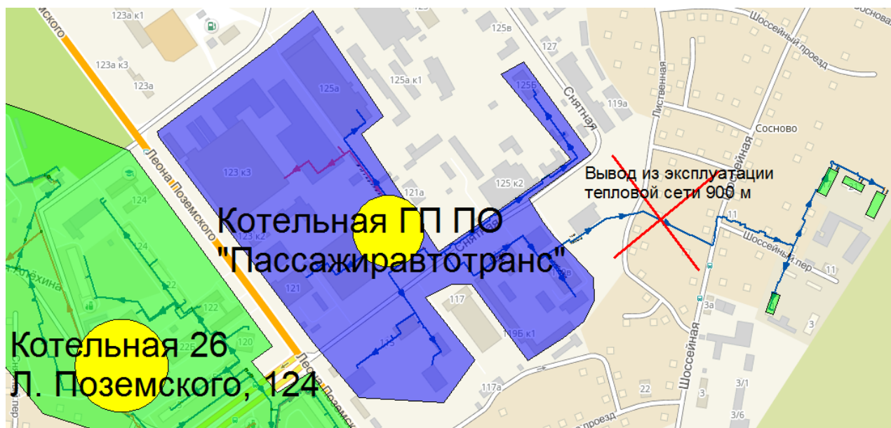
Рисунок 16 – Мероприятие по отключению 4 жилых домов от котельной ГП ПО «Пассажиравтотранс»
